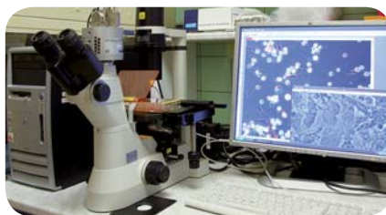
Epifluorescenční invertovaný mikroskop sloužící ke studiu živých buněk přímo v kultivačním médiu
