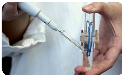
Franzova cela používaná při studiu látek ovlivňujících přestup léčiv přes kůži
